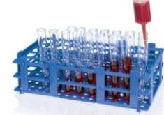
Dosage séquentiel avec HandyStep® touch S et pointe DD tip //
